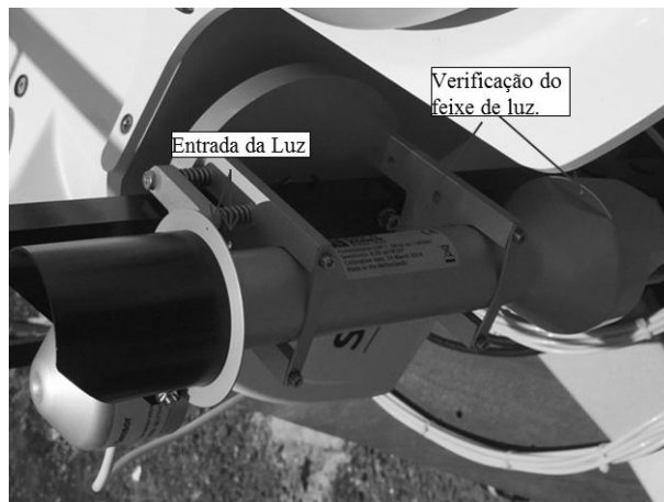
Figura 16: Alinhamento do rastreador e do pireliômetro com a identificação das miras.
