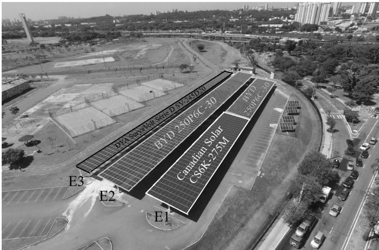
Figura 2 - Sistema BIPV de 510 kWp instalado no estacionamento do Parque Cândido Portinari, em São Paulo/SP.
