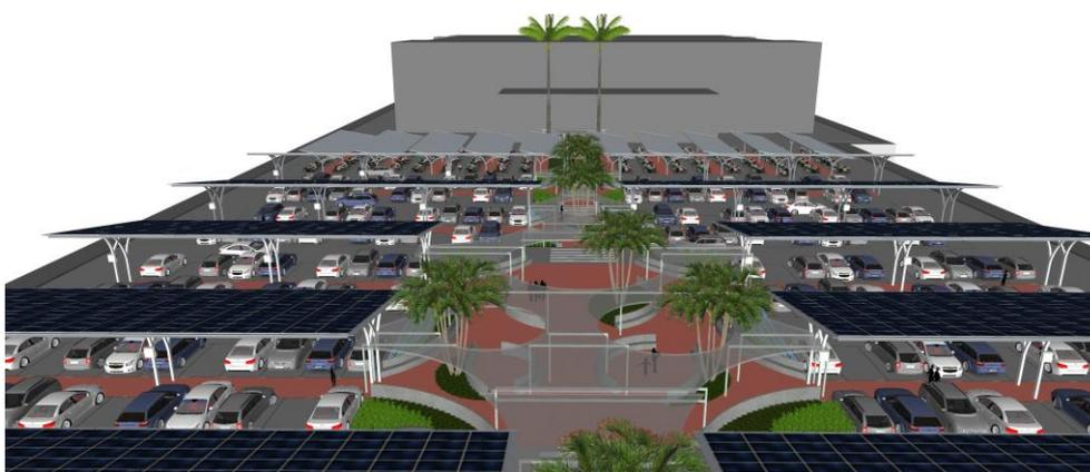
Figura 9 - Detalhe dos jardins centrais, com destaque para a cobertura parcial de policarbonato fixado em pérgolas metálicas.
