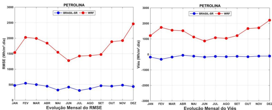
Figura 7 - Comparação da evolução mensal dos índices RMSE e Viés da irradiação global ( $\text{Wh/m}^2.\text{dia}$ ), média mensal das integrais diárias, durante o ano de 2014, pelo modelo BRASIL-SR (linha azul) e pelo modelo WRF, (linha vermelha), para a estação de Petrolina-PE.
