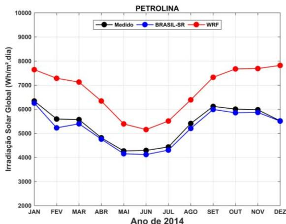
Fig. 5. Comparação da irradiação solar global ( $\text{Wh/m}^2.\text{dia}$ ), média mensal das integrais diárias, durante o ano de 2014, a partir dos dados observados (linha preta) com os dados simulados pelo modelo BRASIL-SR (linha azul) e os dados simulados pelo modelo WRF, (linha vermelha), para a estação de Petrolina-PE.
