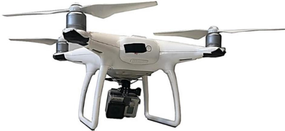
Figura 6 – GoPro HERO 3 Plus Black® adaptada a um VAnT DJI Phantom 4 Pro.
