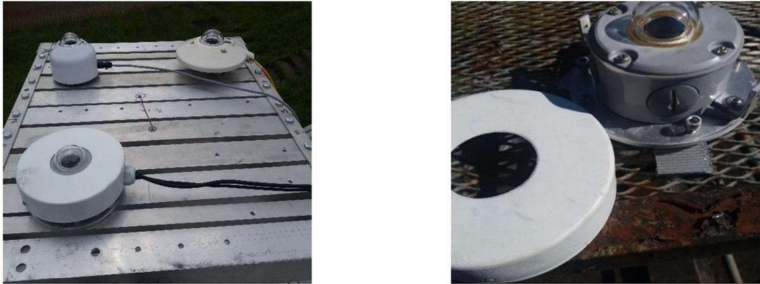
Figura 1 – Imagens do protótipo do piranômetro térmico. Na imagem à esquerda o protótipo está em primeiro plano. Os instrumentos no segundo plano são piranômetros comerciais utilizados para medições comparativas. Na imagem à direita há um detalhe do instrumento com o escudo desmontado.
