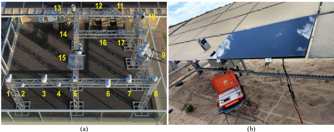
Figura 1 - Estação solarimétrica localizada no laboratório de pesquisa Fotovoltaica-UFSC em Florianópolis-SC (27°S, 48°O), equipada com espectroradiômetro estacionário EKO MS-711 (a); e medições espectrais feitas com o espectroradiômetro portátil EKO MS-720 em Assu-RN (5°S, 37°O) (b).
