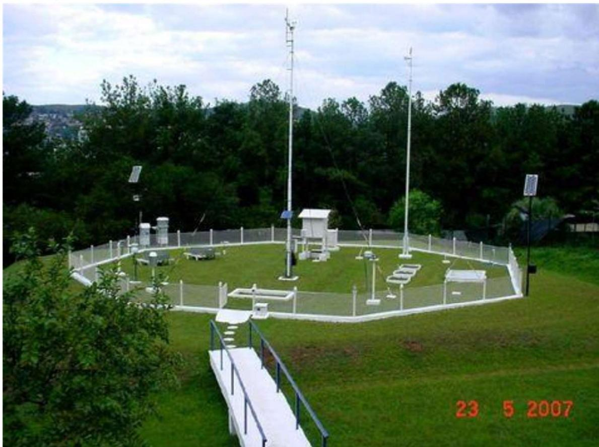
Figura 3 - Estação meteorológica automática do INMET em Porto Alegre.
