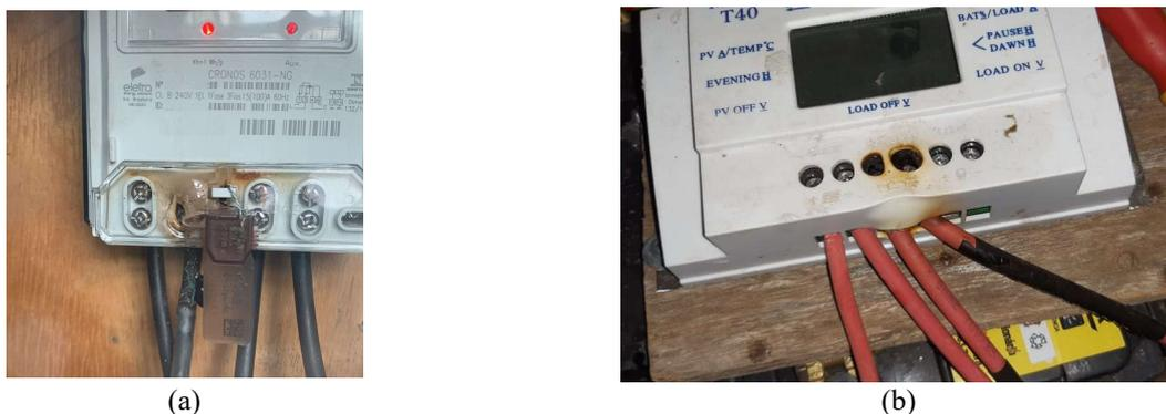
Figura 8 – (a) Falha em um medidor e (b) em um controlador de carga, ambos por torque insuficiente nos bornes.
