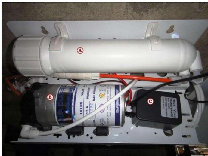
Figura 7 – Parte superior do equipamento de dessalinização com tampa aberta. Fonte: (Rosa, 2013).
