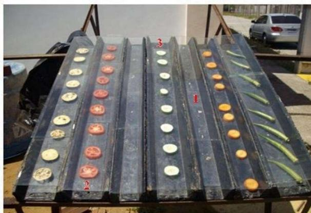
Figura 14 – Secadores solares propostos, em teste (1-luminária menor, 2-luminária intermediária, 3-luminária maior).
