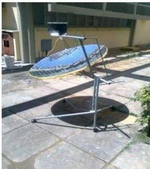
Figura 10 – Fogão solar proposto. Fonte: (Macedo Neto *et al.*, 2011).
