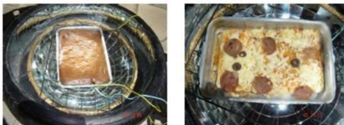
Figura 12 – Fogão solar tipo caixa construído com sucata de pneu. Fonte: (Gomes *et al.*, 2016).
