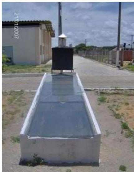
Figura 13 – Sistema de secagem de exposição direta ou indireta em convecção forçada. Fonte: (Barbosa, 2011).
