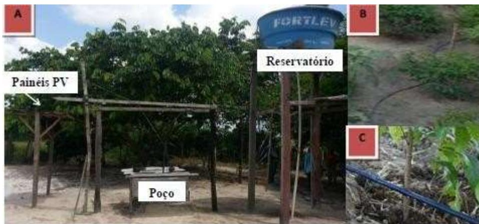
Figura 5 - (A) Sistema fotovoltaico de bombeamento para irrigação; (B) Distribuição de água aplicada com mangueiras perfuradas; (C) Mangueira para irrigação. Fonte: (Campos e Alcantara, 2018).
