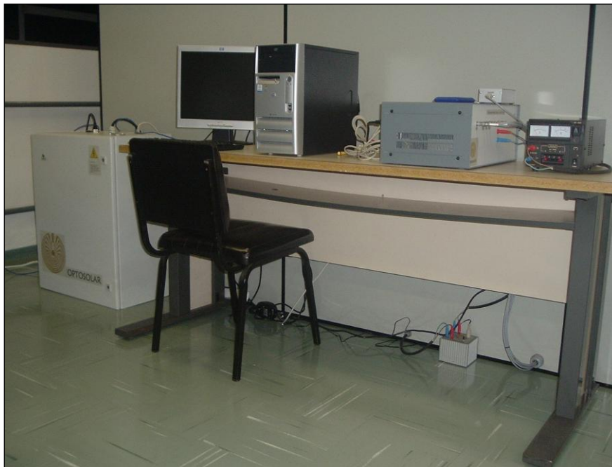
Figura 3- Fonte de alimentação da lâmpada e sistema de medição do simulador solar.
