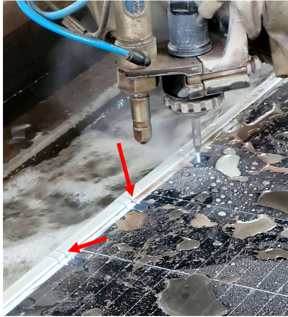
Figura 3 - Processo de corte dos corpos de prova.
