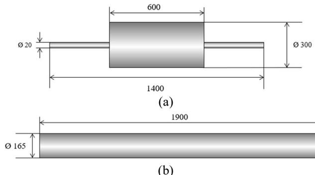
Figura 1 – Comparação das dimensões da câmara de quartzo (a) do forno compacto e (b) do forno convencional para difusão de dopantes. Dimensões em milímetros.
