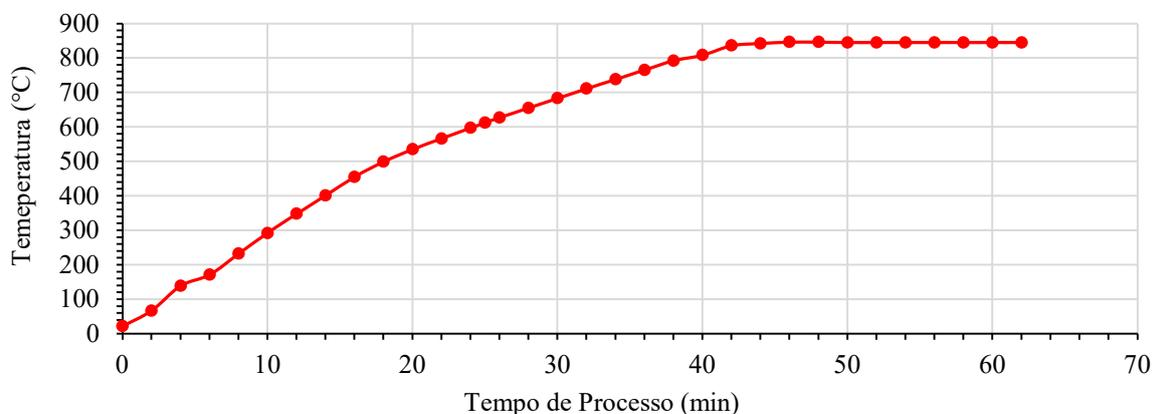
Figura 4 – Curva de aumento da temperatura em função do tempo para atingir a temperatura de 845 °C para formar o emissor n<sup>+</sup> de fósforo.
