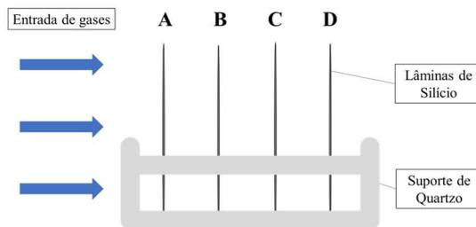
Figura 2 – Esquema do suporte (*carrier*) de quartzo, especificando as posições das lâminas de silício e a direção do fluxo de gases empregada.
