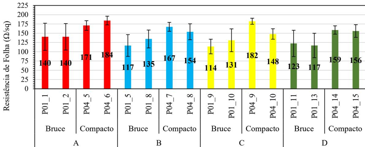
Figura 6 – Comparação entre os resultados obtidos da resistência de folha no emissor  $n^+$  de fósforo produzido no forno compacto nacional e no forno convencional (Bruce) de difusão com tubo de quartzo.
