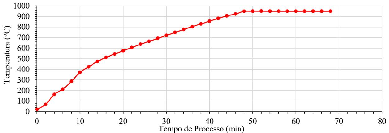
Figura 5 – Curva de aquecimento em função do tempo até a temperatura de 950 °C para o processo de produção do campo retrodifusor p<sup>+</sup> de boro.
