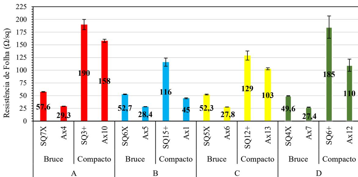
Figura 7 – Comparação entre os resultados obtidos da resistência de folha no campo retrodifusor  $p^+$  de boro produzido no forno compacto nacional e no forno convencional (Bruce) de difusão com tubo de quartzo.
