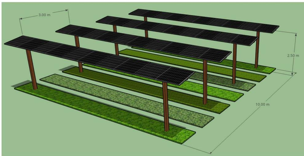
Figura 2 - Sistema agrivoltaico elevado
