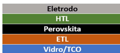
Figura 3 - Estrutura de uma célula de perovskita planar n-i-p. Fonte: Adaptado de Zhang, et al. , 2023.
