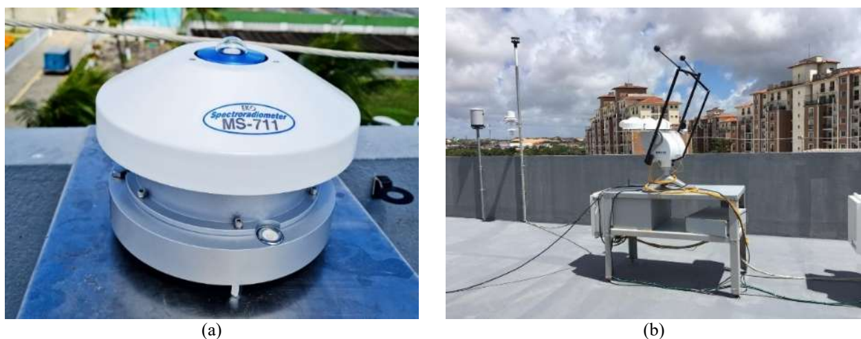
Figura 1 – (a) Vista do espectrorradiômetro MS711 e (b) da estação solarimétrica do ISI-ER.
