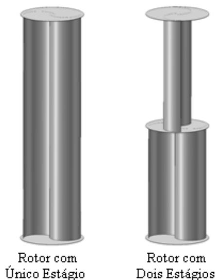
Figura 1- Rotor Savonius abordado nesse estudo, à esquerda, e sua opção em duplo estágio, à direita.
